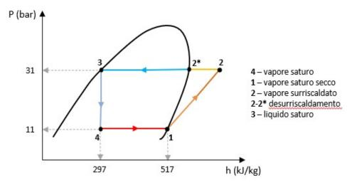
Fissando la pressione a 11 bar, l'R32 evapora alla temperatura di circa 10°C, portando poi la pressione a 31 bar condensa alla temperatura di circa 50°C.
