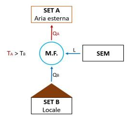
• **Pompa di calore** - il COP rappresenta il rapporto tra l'energia termica da fornire al SET a temperatura superiore e l'energia meccanica spesa:
